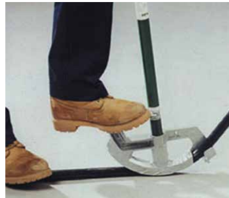
Use un adaptador Hickey para reducir la posibilidad de daño del recubrimiento de la tubería.
